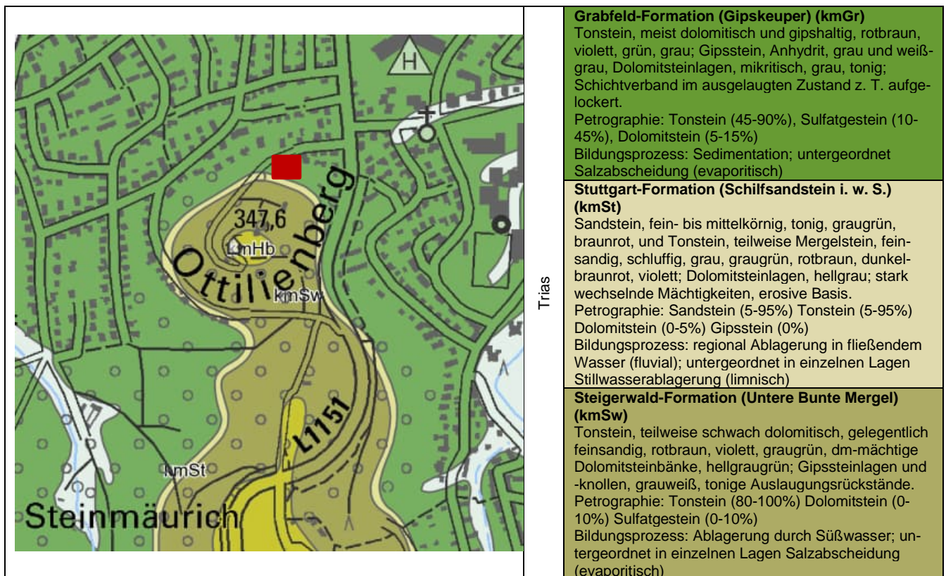
Abbildung 2: Auszug aus der Geologischen Karte 1:50.000 GK50 [4] mit Baufeld in Rot.
